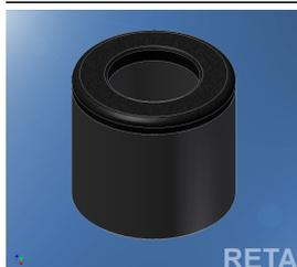
Kode 1889Cxx Bestehende vollst&auml;ndige Feder von Feder in Gummi und Scheibe. H&auml;rte Standard 50 Shore. Verf&uuml;gbar in verschiedene L&auml;ngen, zur Zeit 32, 27 19 21. Nur thermoplastischer Gummi haftende zu alle Regelungen. NEIN PVC. der Doppel kleine x in der Kode dient, auf die L&auml;nge zu zeigen. Schwarze Farbe.
